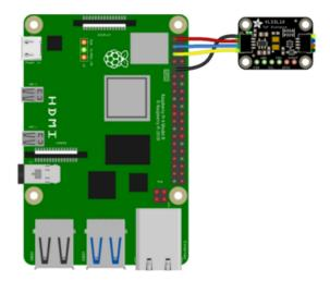
Pi 3V to sensor VIN (red wire)
