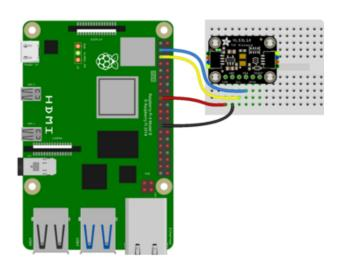
Pi 3V to sensor VIN (red wire)
